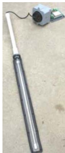
Figure 8 – Retrait du cadre de support de la lampe UV
