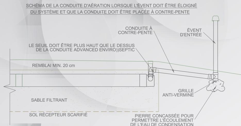
Autrement, l'évent d'entrée pourrait se remplir d'eau, obstruant complètement le circuit d'aération et menant à l'évacuation de gaz, donc d'odeurs, par l'évent d'entrée.
