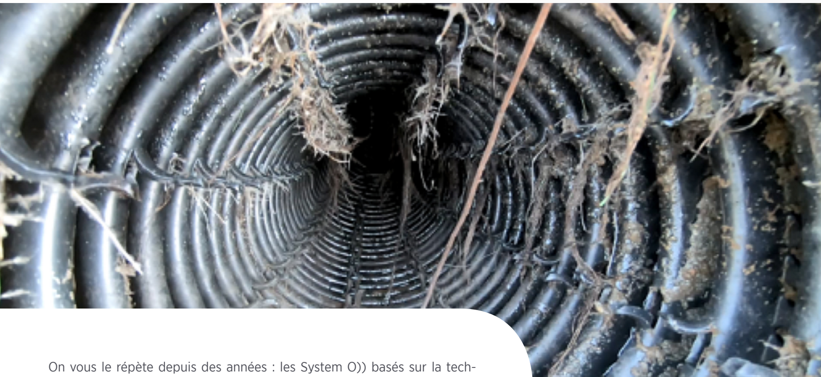
Figure 1. Intérieur d'une conduite ENVIRO-SEPTIC provenant d'un système en fonction depuis 15 ans.
